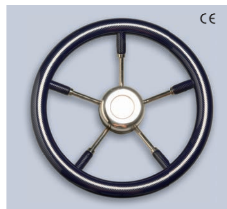
Cod. V.CC 35 Ø 350 Volante in acciaio inox con impugnatura tipo cubico. Vedi disegno C
