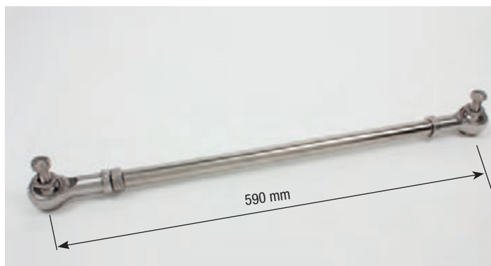
Cod. 358.06 Collegamento motore - motore Barra di accoppiamento in acciaio inox aisi 316 per applicazioni con singolo o doppio cilindro bilanciato.
