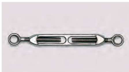
Tenditori a due occhi in acc. inox 316. Filettatura metrica canala aperta. Rigging screws 316 stainless steel eyes with thread metrics open body.
