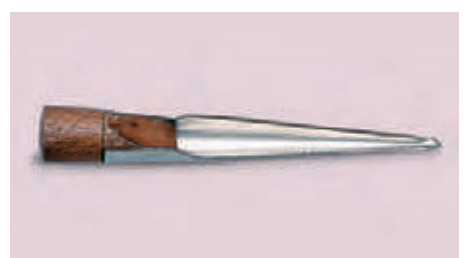
Caviglia inox per impiombature. Stainless steel fid.
